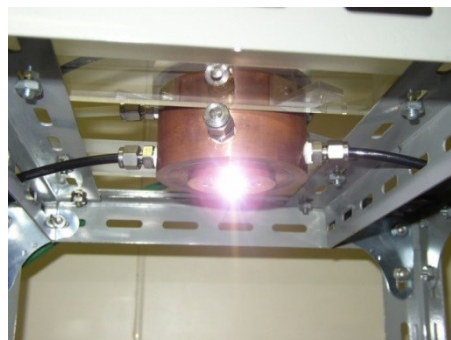
図4. 作製した装置により生成した大気圧熱プラズマジェット
