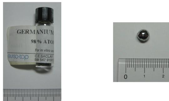
図 39  ${}^{73}\text{Ge}$  濃縮 (98%) 原料 (左) と  $\text{URu}_2(\text{Si}_{0.9}, {}^{73}\text{Ge}_{0.1})_2$  のインゴット (右)
