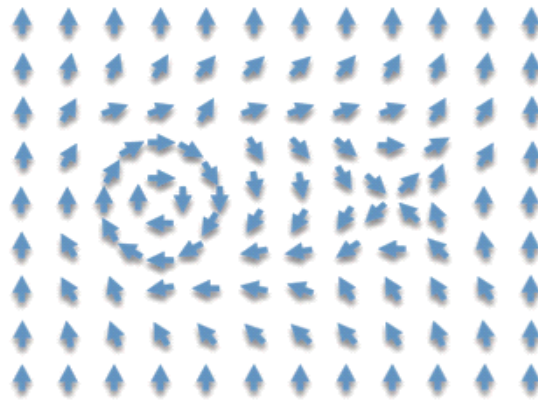
図 2.2 2次元正方格子上の XY 模型における渦の様子。左側に渦度 +1 の正の渦、右側に渦度 - 1 の負の渦がある。
